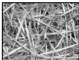
3.5. Biomata S-100-P ze słomy zbożowej umieszczonej pomiędzy siatkami z polipropylenu
